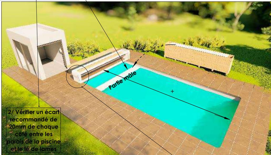
2/ Vérifier un écart recommandé de 20mm de chaque côté entre les parois de la piscine et le lé de lames
